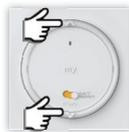
**ÉTAPE 2 :** Rester appuyé simultanément sur « **Montée** » et « **Descente** » jusqu'à la réaction du volet (6 sec.) Les fins de course sont effacées, le volet fonctionne en « **pas à pas** ».
