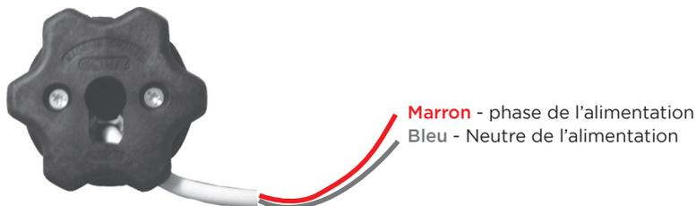
**i** Le moteur Altus RTS n'a pas besoin d'être raccordé à la Terre car il est «double isolation» (classe II).
