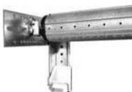
4- Engager la pièce 3 de l'ensemble «Axe» dans Le coussinet 5 . Bloquer l'axe grâce à la goupille 4.
