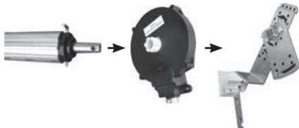
2- Enlever la rondelle et la goupille fendue du compensateur 3. Engager le compensateur 3 dans le treuil 8 puis sur le coussinet 9.
