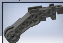
Pièce à fixer par 1 vis avant d'enfiler le moteur dans son rail
