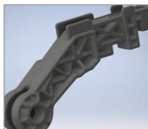
Liaison bras moteur au moteur, pour un rail moteur en position poussant (option)
