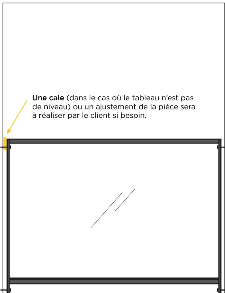
**Une cale** (dans le cas où le tableau n'est pas de niveau) ou un ajustement de la pièce sera à réaliser par le client si besoin.
