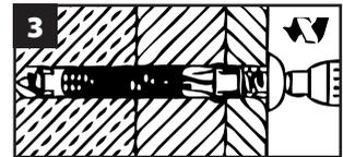
Maçonnerie creuse (sous réserve d'un essai)
