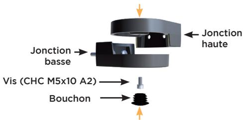
Dans le cas d'une jonction d'angle rampant :
