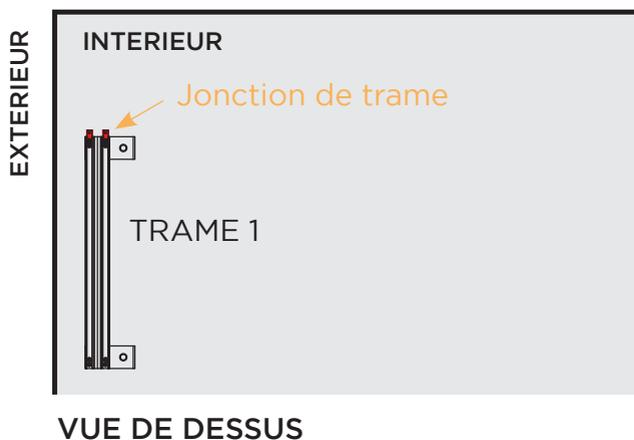
**3 - Déserrer les vis de la trame 2 et l'emboîter dans la trame 1.**
