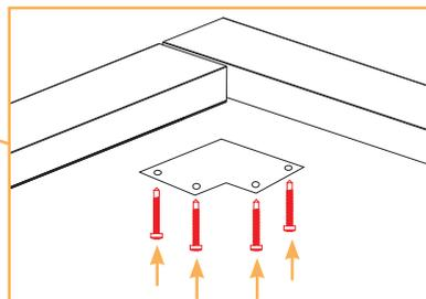
Les profils doivent se toucher puis positionner l'équerre de maintien puis visser pour bloquer l'angle (Vis Tole TF Pozi 4,2 x 19 A2).
