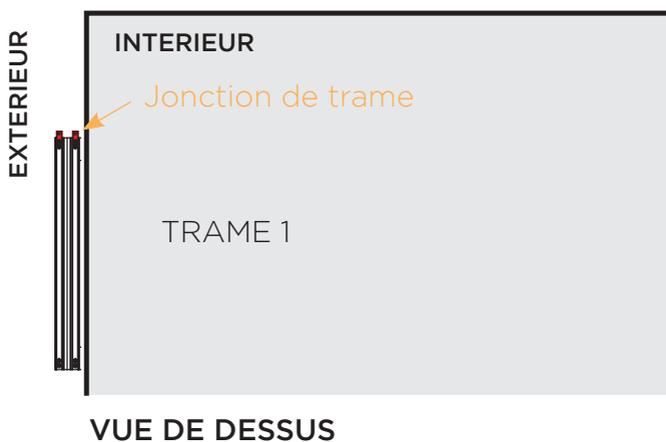
**3 - Déserrer les vis de la trame 2 et l'emboîter dans la trame 1.**
