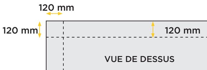
Pointer 120 mm aux deux extrémités puis tracer à l'aide d'un cordeau traceur pour palier à d'éventuels défauts de maçonnerie.
