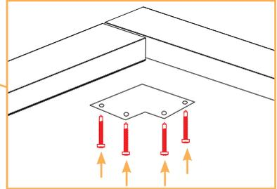
Les profils doivent se toucher puis positionner l'équerre de maintien puis visser pour bloquer l'angle (Vis Tole TF Pozi 4,2 x 19 A2).
