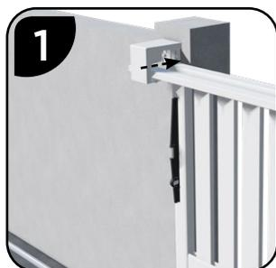
Positionner le portail sur le rail inférieur vérifier l'aplomb et tracer les perçages.
