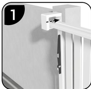
Positionner le portail sur le rail inférieur vérifier l'aplomb et tracer les perçages.
