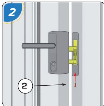
**i** Possibilité de régler horizontalement le pêne et la butée
