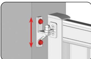
**☐** Pour aligner les vantaux horizontalement, utilisez la vis de la tête de gond ainsi que les vis de fixations de la pente.
