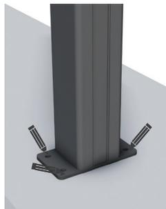
2- Placer le poteau sur le muret et tracer les trous de perçage.
