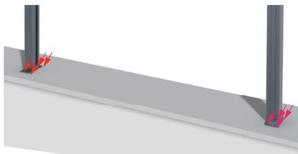
4- Fixer les poteaux en utilisant les fixations appropriées au support (non fournies). Contrôler les niveaux et l'aplomb en respectant les longueurs de trame entre poteaux indiquées sur la commande.
