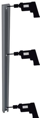
1- Percer le profil au diamètre et endroit souhaités.
