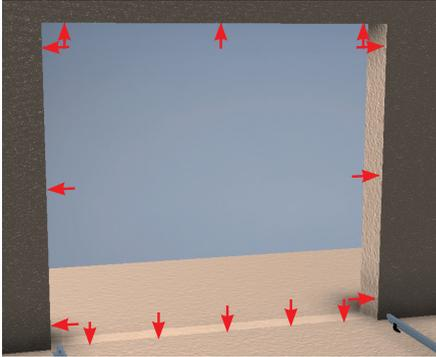
**9** Appliquer un cordon de mastic sur toute la largeur de maçonnerie, + remonter de 20 mm sur le tableau, aligné à l'écoinçon.
