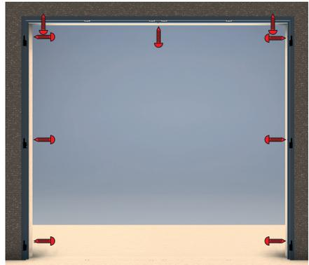
**11** Fixer le seuil à l'aide des vis tête bombée (TB) 5 x 45 mm.
