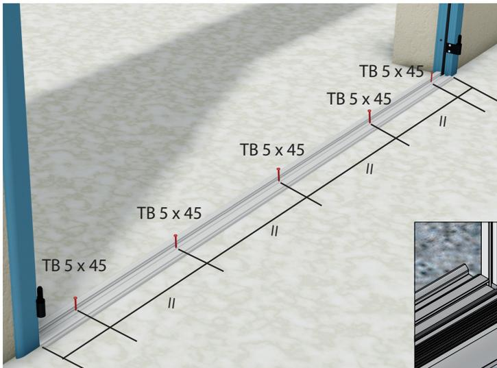
Appliquer un cordon de mastic à la jonction seuil/montant précadre côté extérieur et en bas des montants.
